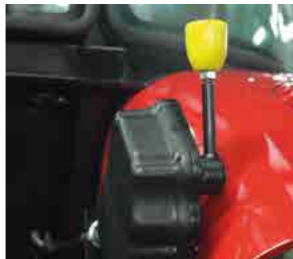
Commande hydraulique externe des modèles 60X, 70X, 80X et 85X
