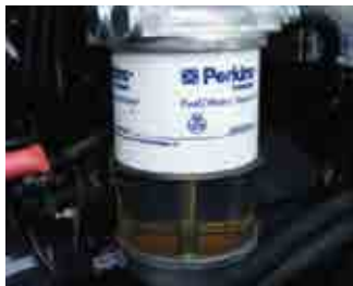
Filtre de retenue d'eau
