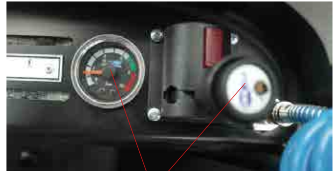
Ventil Feststellbremse und Druckmanometer
