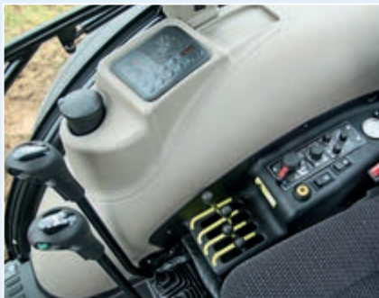
Das Panel für die EHR und die Beleuchtung ist gelungen, auch die Hebel für Gang- und Wendeschaltung sind okay. Die Hebel für die vier Steuergeräte sitzen viel zu eng zusammen – und es gibt keine Schwimmstellung.
