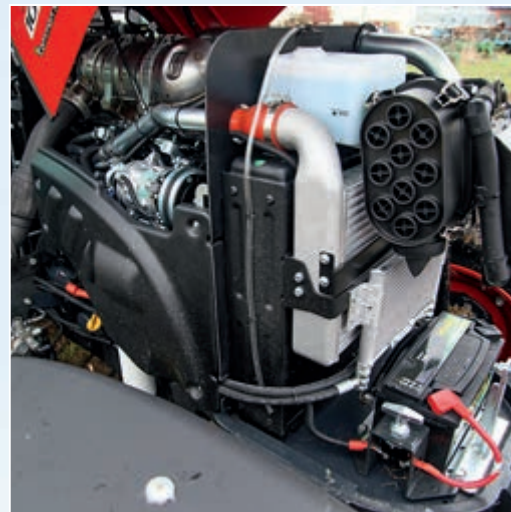
Unter der Haube steckt ein Deutz-Vierzylinder mit 3,6 l Hubraum und Abgasstufe IIIB. Hinten über dem Motor ist der DPF/DOC zu erkennen.
