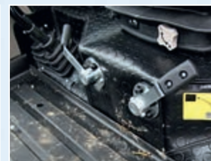
Die Kabine (mit Klimaautomatik!) macht einen ordentlichen Eindruck. Die Hebel für die vier Zapfwellengeschwindigkeiten und die Gruppenschaltung unten vor dem Sitz stören da eher.
