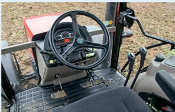
Die Kabine (mit Klimaautomatik!) macht einen ordentlichen Eindruck. Die Hebel für die vier Zapfwellengeschwindigkeiten und die Gruppenschaltung unten vor dem Sitz stören da eher.
