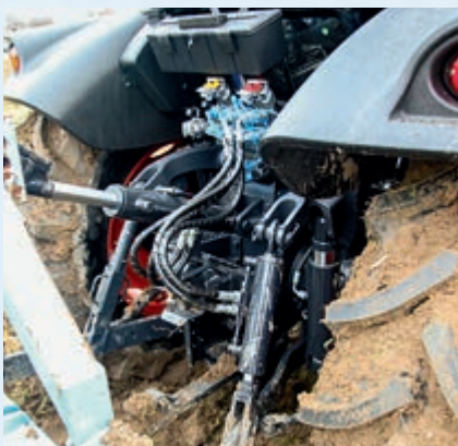
Die Hubkraft ist mit stolzen 5000 daN angegeben, serienmäßig gibt es den hydraulischen Oberlenker und die Hubstrebe. Eine externe Bedienung gibt es nur rechts.
