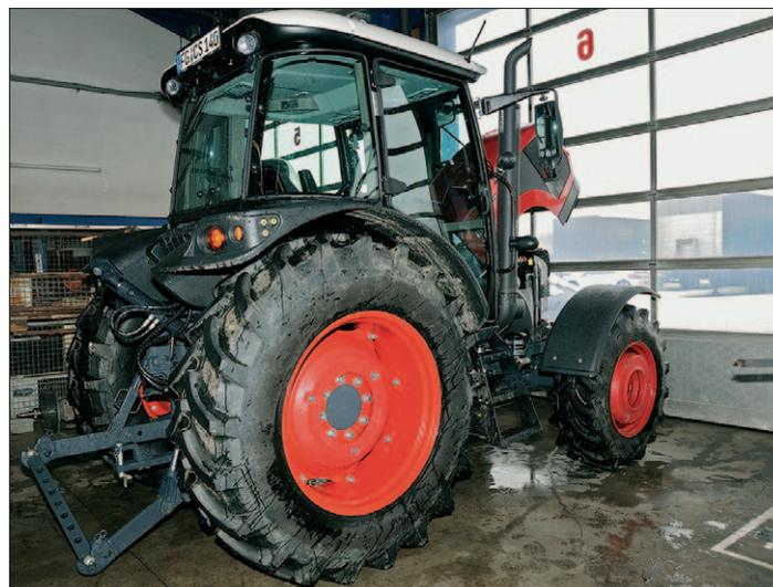
Der ArmaTrac des türkischen Herstellers Erkunt wirkt robust und kompakt. Vom Generalimporteur Schneider LFB wird der Allrad-Schlepper mit Radialreifen, Frontgewichten und Radballast ausgeliefert.
