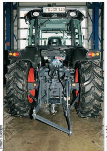
Heck des ArmaTrac mit Maul- und Pendelkupplung sowie einer Auswahl an Anschlüssen für Hydraulik und Luft.
